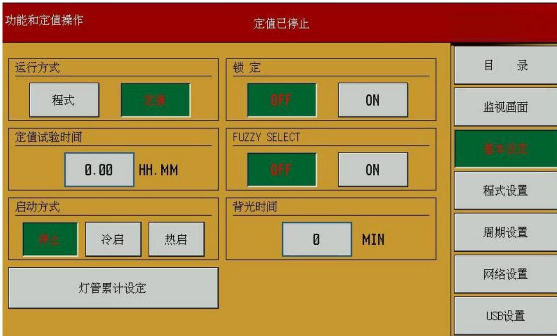
1、USB 设置： 单击选中 USB 设置页面可以对其进行 USB 设置操作，其中可以对其进行状态，参数，实时曲线保存等进行编辑设置。
